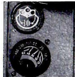
La cellule réagit, en fonction de l'intensité lumineuse, sur un galvanomètre autocoil, étudié spécialement, dont l'aiguille se déplace dans le viseur réflexe.
