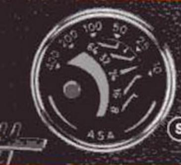
— Régler le système sensito-métrique, au moyen du bouton (20), en amenant le degré de sensibilité du film (en degrés ASA) en face de celui de la vitesse de prise de vues utilisée (S).
