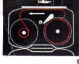
Avant de refermer le couvercle, pressez sur le déclencheur une fraction de seconde pour vous assurer que le film est entraîné normalement.
