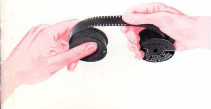
film tout en serrant le film sur la bobine vierge pour qu'il ne se déroule pas, introduisez l'extrémité dans la fente de la bobine réceptrice. Bien ancrer et emboîmer quelques tours de film, la bobine pleine toujours serrée dans la main droite.
