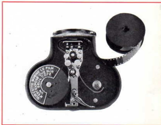
l'axe de réembobinage (n° 11), en ayant soin que le petit ergot en bas de l'axe entre dans une des encoches de la bobine. Le film doit se dérouler de l'intérieur de l'axe vers l'avant, en suivant le tracé rouge sur la platine.
